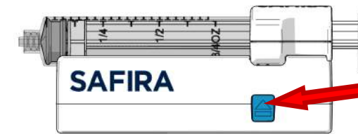
Schéma #5 : appuyez sur le bouton carré bleu pour retirer la seringue stérile.
