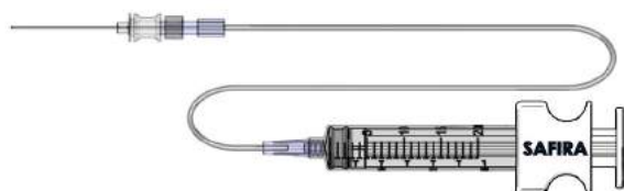
Schéma #1 : aiguille préparée pour insertion dans le raccord luer de la seringue SAFIRA
